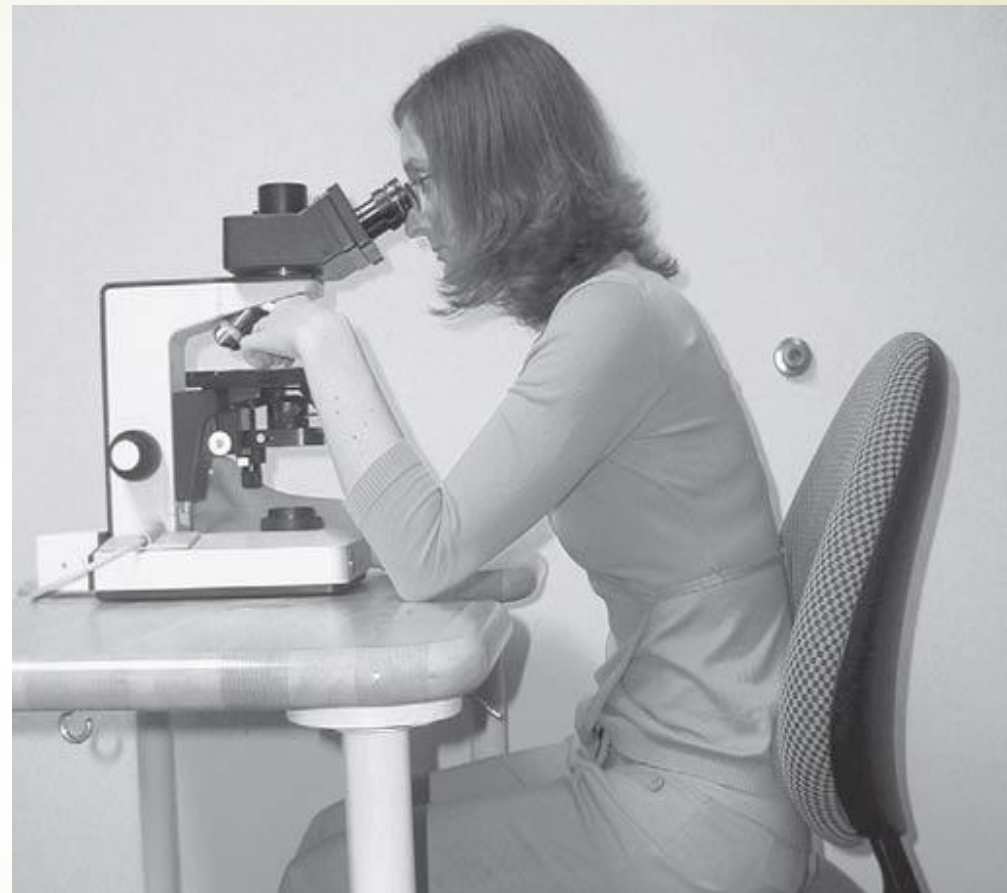
میکروسکوپ های معمولی با زاویه ی حاده و ثابت چشمی نسبت به تنه ی میکروسکوپ
